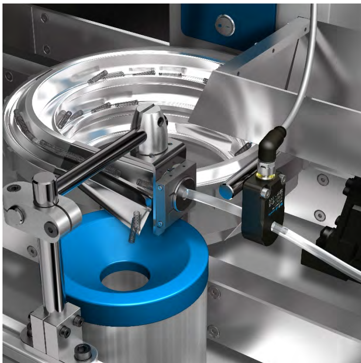
Bild 2: Die induktiven Ringsensoren der IRSD-Serie von di-soric erkennen kleinste Metallteile exakt und zuverlässig – selbst bei hohen Geschwindigkeiten und in schmutzigen Umgebungen.
